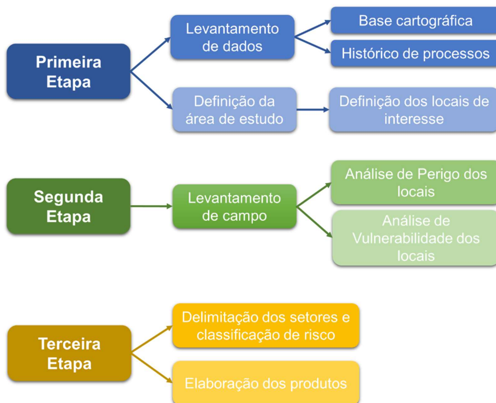
Figura 83 – Etapas da metodologia adotada para o mapeamento das áreas de risco geológico e hidrológico da área urbana do município de Tunápolis/SC.
